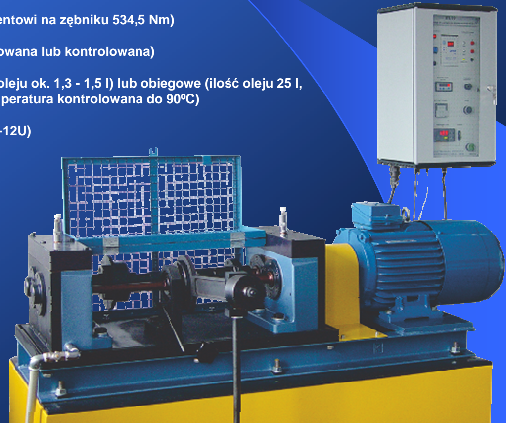
Uniwersalne stanowisko przekładniowe T-12U (typu FZG)
