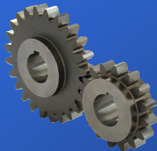
Koła testowe FZG typ C/GF
